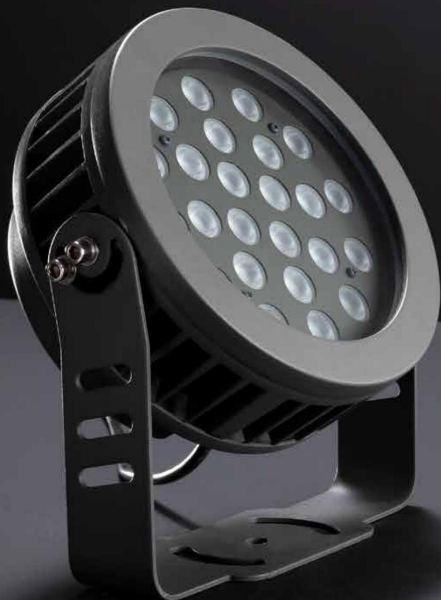
Proiettore Led da esterno 230 Vac disponibile nelle versioni monocolor 3000K e RGBW, ideale per l'illuminazione di facciate e per creare scenari di luce colorata. L'elettronica di comando è integrata all'interno del proiettore e permette il comando wireless tramite radiocomando o smartphone da remoto con l'App OneSmart.
