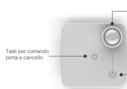
Sensore di movimento e luminosità. Distanza di rilevamento impostabile da 30 cm a 6 metri, angolo 120°, soglia di luminosità settabile su 6 livelli
